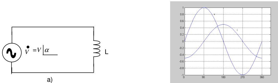
Fig. 8.6 – Tensão e corrente em um indutor
